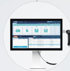
中央控制系统标配 22 寸超灵敏触摸屏，支持佩戴手套操作，人机交互体验更佳。配合专业的操控软件，单台电脑即可控制整条流水线。
